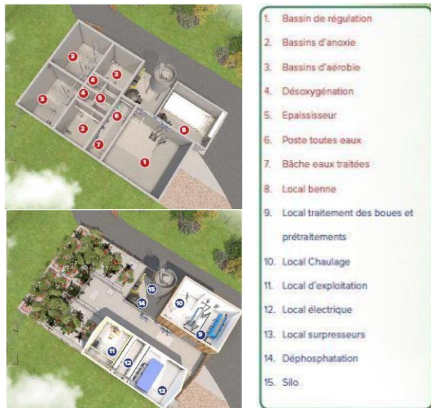
Figure 15 : Exemple de STEP Organica pour 2 000 EH. Source : Présentation MSE
